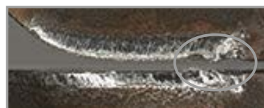
Filo de corte dañado
